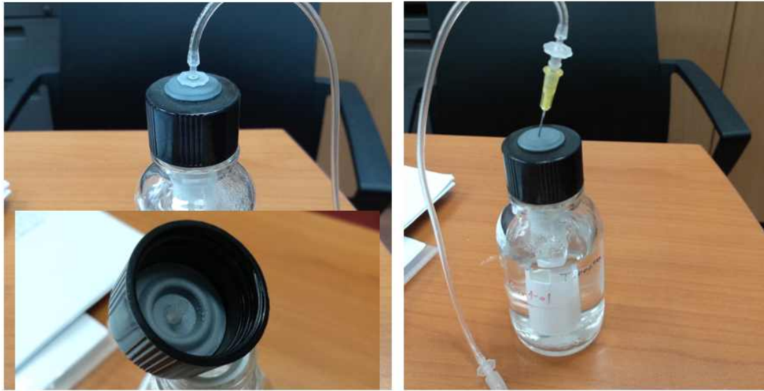
그림. 생물반응조와의 연결 방법(Left: Gas production, Right: O 2 consumption)
